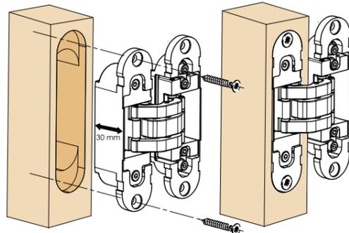
**IT - Inserir la parte delle cerniere marchiata "door"** (profondità 30 mm) nelle fresate dell'anta avendo cura di scegliere il corretto verso di apertura, fissare quindi le cerniere avvitando le appropriate viti da legno.
