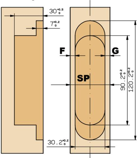
**Fresatura lato telaio**
