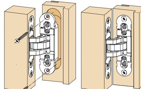
2 ES - Monte la puerta sobre el pilar, introduciendo la parte marco de las bisagras (profundidad 21 mm) en las ranuras correspondientes, luego fijelas enroscando los tornillos específicos.
