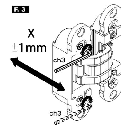
ES - AJUSTE LATERAL El ajuste lateral se realiza sobre la parte bisagra introducida en la puerta con una llave hexagonal de 3 mm, actuando alternativamente sobre los dos tornillos indicados en la figura 3.
