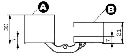
**DE - Montage Darstellung von einem Band, das sich in der Mitte der Tür befindet.**
