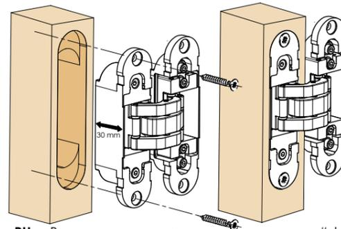
1 ES - Introduzca la parte de las bisagras marcadas "door" (profundidad 30 mm) en las ranuras de la puerta, eligiendo con atención el correcto sentido de apertura, luego fijelas enroscando los específicos tornillos para madera.
