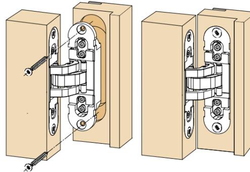
**IT - Montare l'anta sullo stipite** inserendo la parte telaio delle cerniere (profondità 21 mm) nelle apposite fresate, fissare quindi le cerniere avvitando le appropriate viti da legno.
